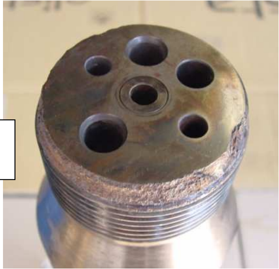
タイト面周囲 腐食痕
