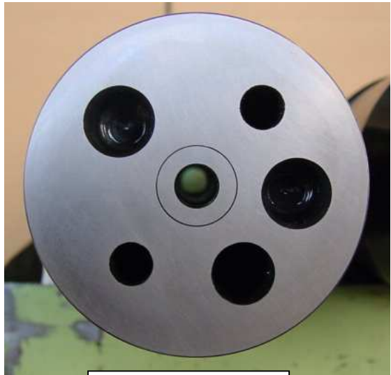
腐食部溶接修理 タイト面研磨ラッピング
