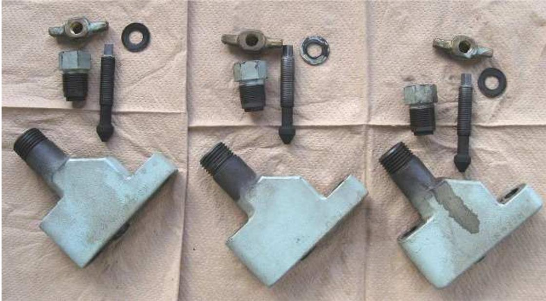
整備完了(弁、弁座削正 組立圧力テスト)
